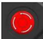
按下此按钮，伺服电源切断，系统将被紧急停止，电机使能被关闭，如果电机有抱闸功能则会抱闸。
