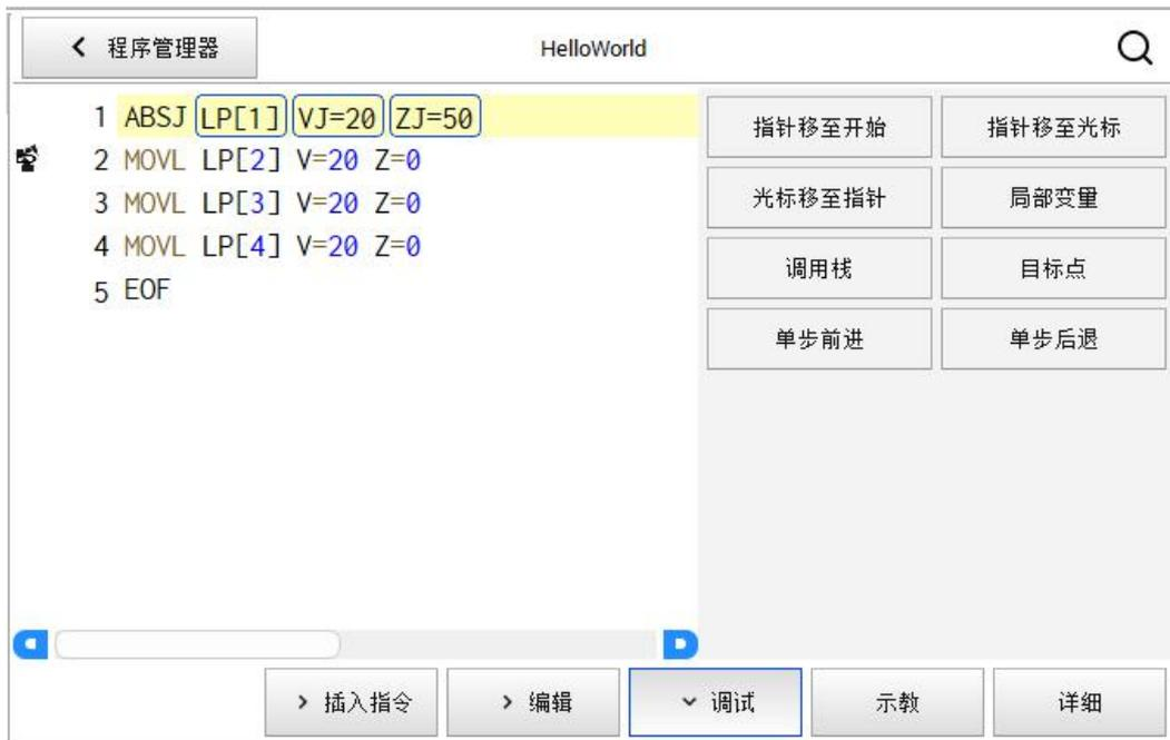
【指针移至开始】：将程序指针移动到主程序文件的第一行，并且初始化所有变量；
