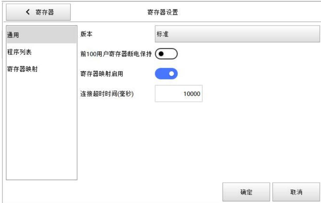
如下图所示，程序列表中可以配置最多 16 个入口程序文件名。当用户通过系统寄存器启动程序时，程序号为此处设定的程序文件。
