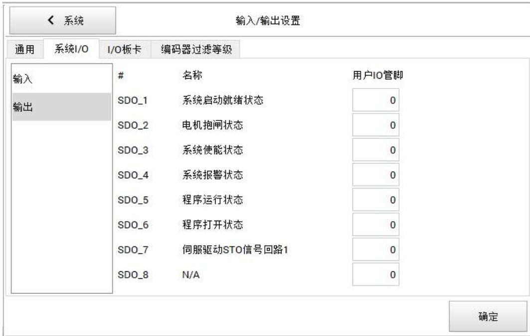
注意，针对 RC80 或者 RC40 控制器，控制器自带的 IO 端子有 3 入 2 出 GPIO。这些 GPIO 可以配置为系统 IO 使用。针对系统 DI，-1 表示 IO 端子的 I0 端子，-2 表示 IO 端子的 I1 端子，-3 表示 IO 端子的 I2 端子。针对系统 DO，-1 表示 IO 端子的 Q0 端子，-2 表示 IO 端子的 Q1 端子。如下图所示，IO 段子的输入输出被映射为系统 IO，I0 对应 TPU 急停输入，I1 对应手动使能输入，I2 对应外部急停输入，Q0 对应系统报警状态输出，Q1 对应程序运行状态输出。
