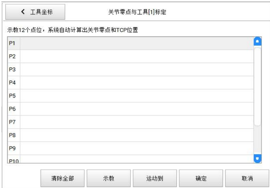
12点标定法，需要在工作台上固定一个参考尖点，操作机器人让 TCP 以 12 个不同的姿态运动到参考尖点并点击【示教】记录点位，最后点击【确定】完成标定。
