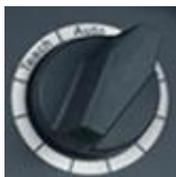
包含三种模式：当旋钮被旋转至左边时，为手动模式；旋转至中间为自动模式；旋转至右边为远程模式。
