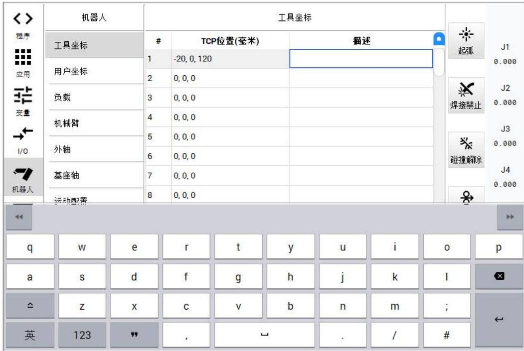
选中某一个工具坐标系后，点击【12点标定法】可以同时标定机器人关节零点和 TCP 的 XYZ，提高机器人绝对精度，如下图所示。
