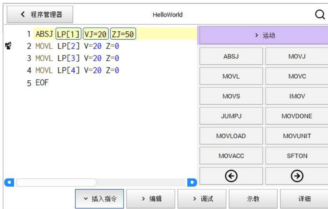
点击【编辑】，程序显示区右侧会显示针对当前选中指令的各种操作，如下图所示。
